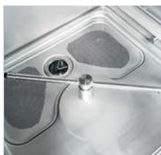
Cuve de lavage avec bras de lavage
